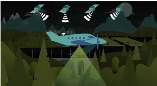
3. Une antenne de positionnement par satellite (GNSS) donne la **position** du capteur LiDAR
