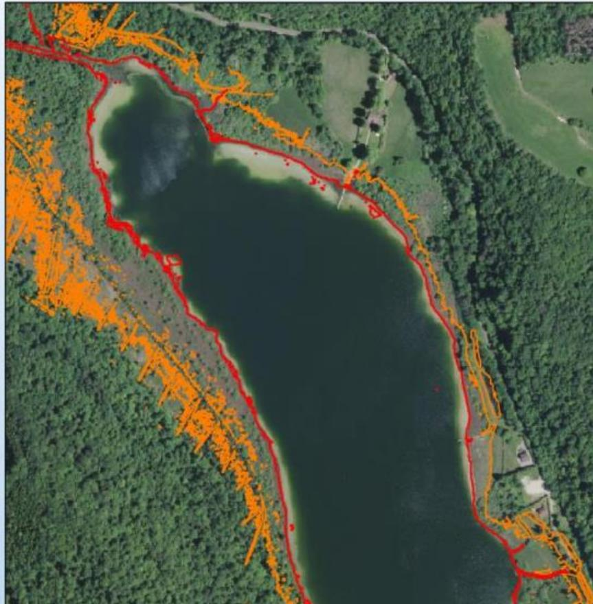
Modélisation de la surface ennoyée avec un débit du Hérisson correspondant au module ( $\sim 1,5 \text{ m}^3/\text{s}$ )
