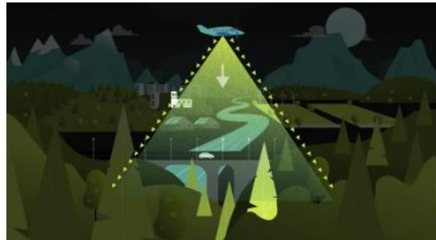
1. Le **scanner** émet des **impulsions laser infrarouge** à haute fréquence vers la scène cartographiée
